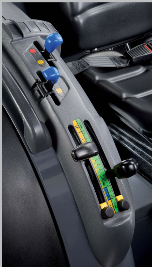
La commande du relevage mécanique garantit le réglage simple et efficace du circuit hydraulique arrière. Le troisième distributeur supplémentaire à distance est actionné via interrupteur à bascule.
