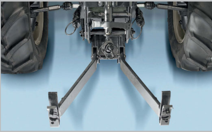
Relevage avant et PDF avant. Le relevage avant vante une force de levage de 600 kg, tandis que la PDF avant délivre un régime de 1 000 tr/min.
