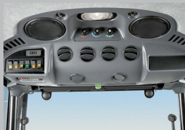
Les commandes de chauffage et de climatisation sont commodément installées sur le pavillon.
