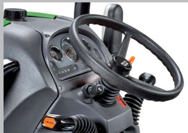
Le volant est réglable en hauteur, permettant à chaque conducteur de trouver la position idéale.
