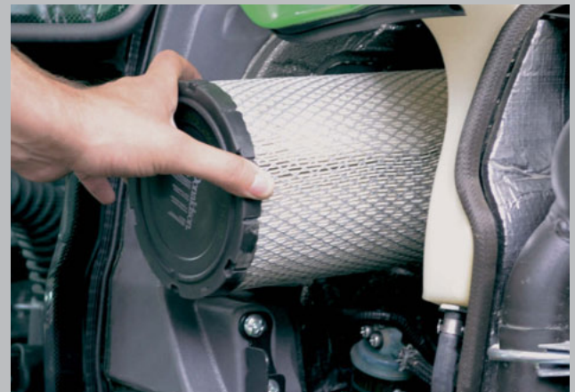
La cartouche du filtre à air s'extrait facilement sur le côté
