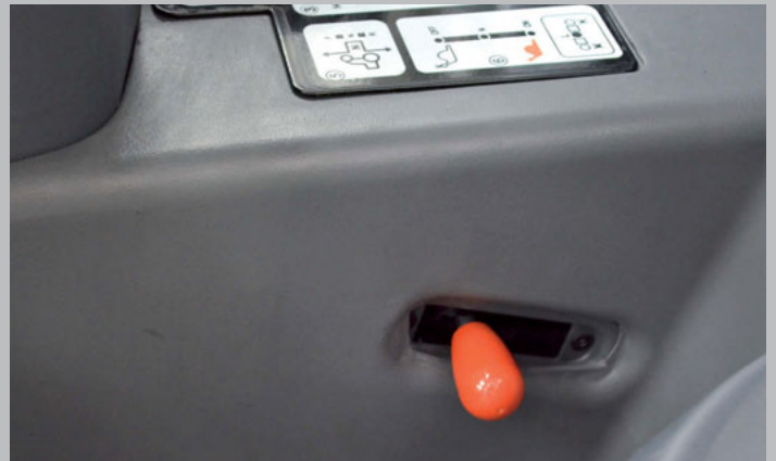
Transmission à super-réducteur : Quatre rapports supplémentaires pour le travail à très basses vitesses.
