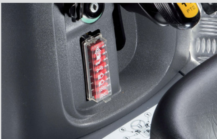
Les fusibles sont situés directement sur la colonne de direction et se remplacent facilement sans devoir systématiquement retirer de couvercle.
