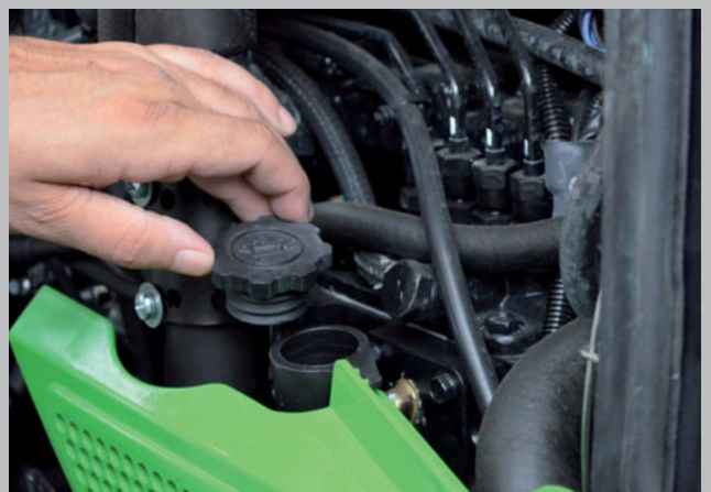
Le goulot de remplissage d'huile et la jauge de niveau sont faciles d'accès.
