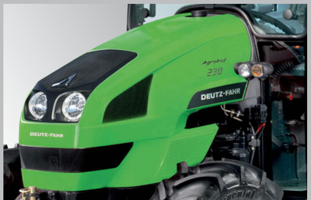
Le matériau utilisé pour le capot est le Telene®, une résine thermodurcissable.
