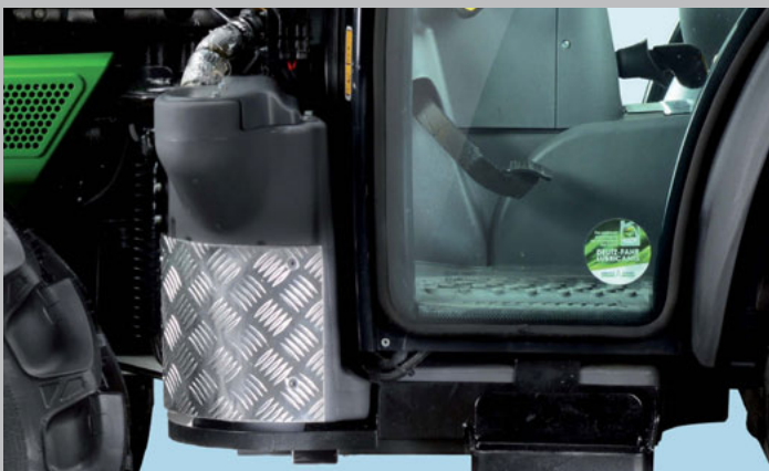
Réservoir à carburant supplémentaire (15 l) : Pour de longues journées de travail sans ravitaillement.
