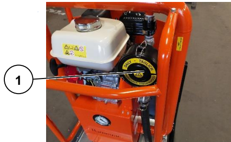
Figure 15 : Contrôle du filtre
