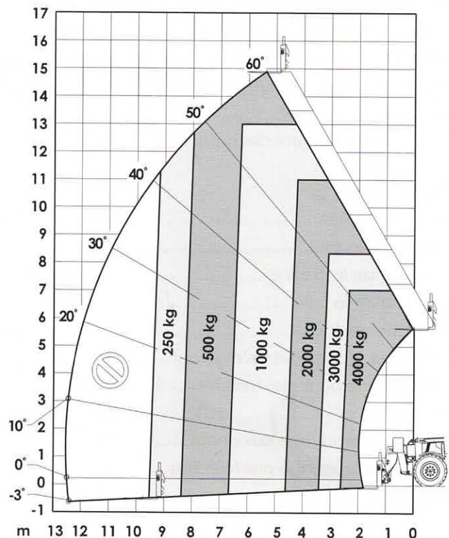
Système de mise à niveau du chassis activé.
