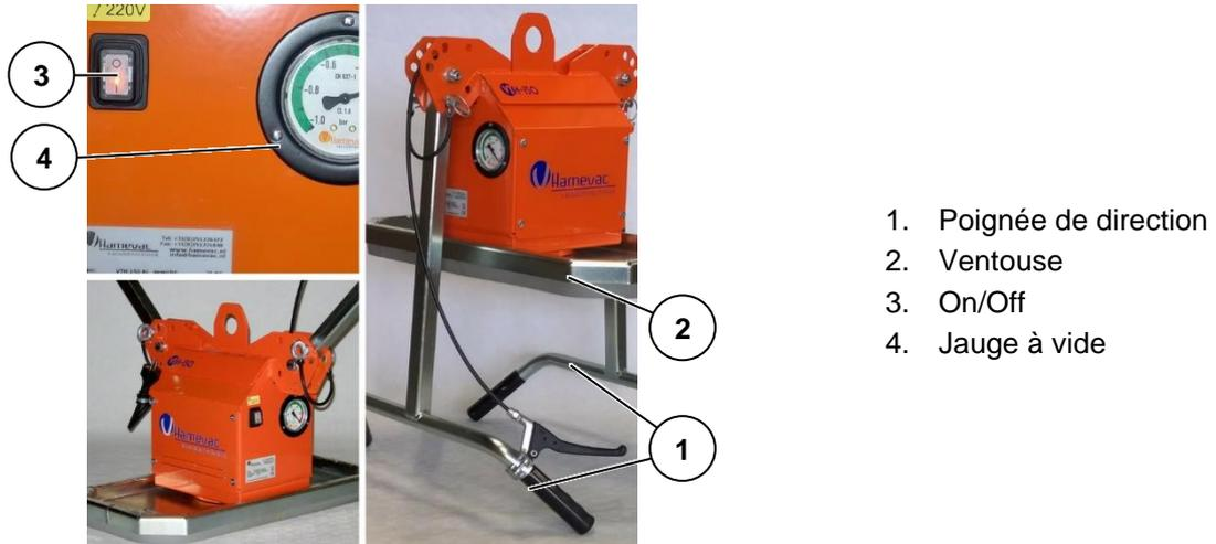
Figure 1 : Principe de fonctionnement
