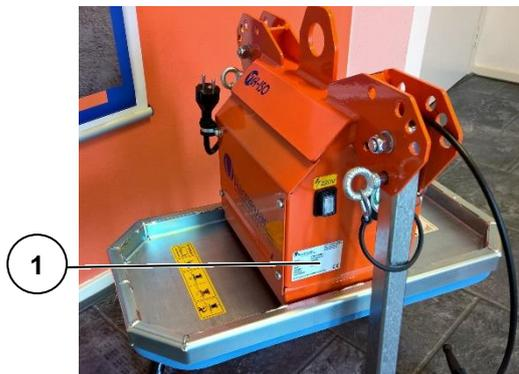
La plaque signalétique(1) se trouve sur le réservoir tampon. Les données suivantes sont indiquées sur la plaque signalétique :
