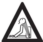
Ne pas porter des vêtements qui risqueraient de se prendre dans le bois, les broussailles ou les pièces en mouvement de la machine. Ne porter ni écharpe ou cravate, ni bijoux. Les personnes aux cheveux longs doivent les nouer et les assurer de telle sorte qu'ils soient maintenus au-dessus des épaules.
